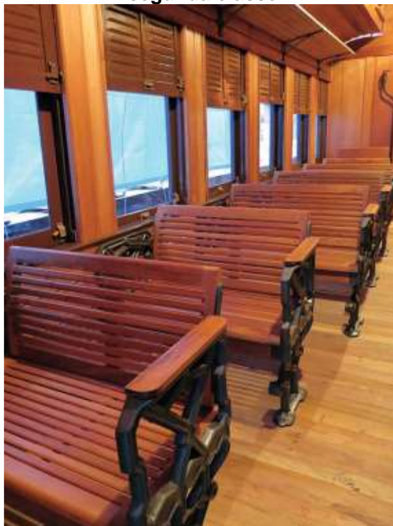
IMAGEM 21: Interior do carro de passageiros após restauração do setor da segunda classe
