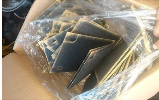
Figura 23 – Elementos filtrantes após a filtragem do óleo
