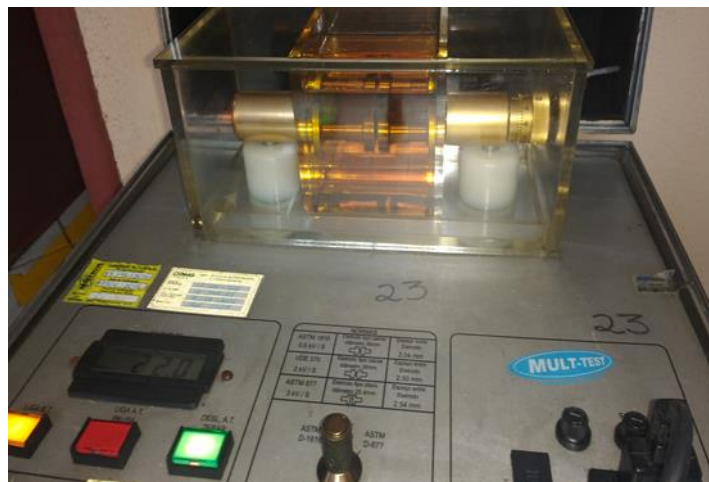
Figura 3 – Equipamento de ensaio de rigidez dielétrica do óleo mineral isolante
