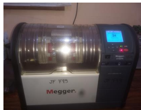
Figura 15 – Equipamento de ensaio de rigidez dielétrica do óleo isolante
