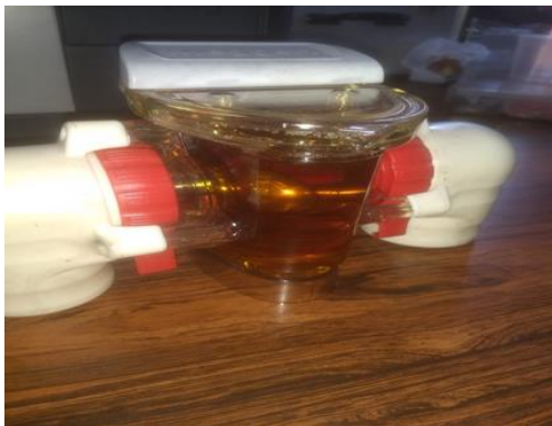
Figura 15 – Equipamento de ensaio de rigidez dielétrica do óleo isolante
