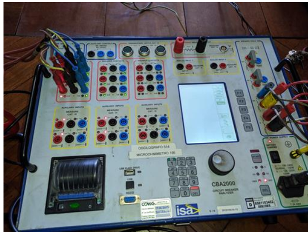
Figura 13 – Modelo de um oscilógrafo digital utilizado no ensaio
