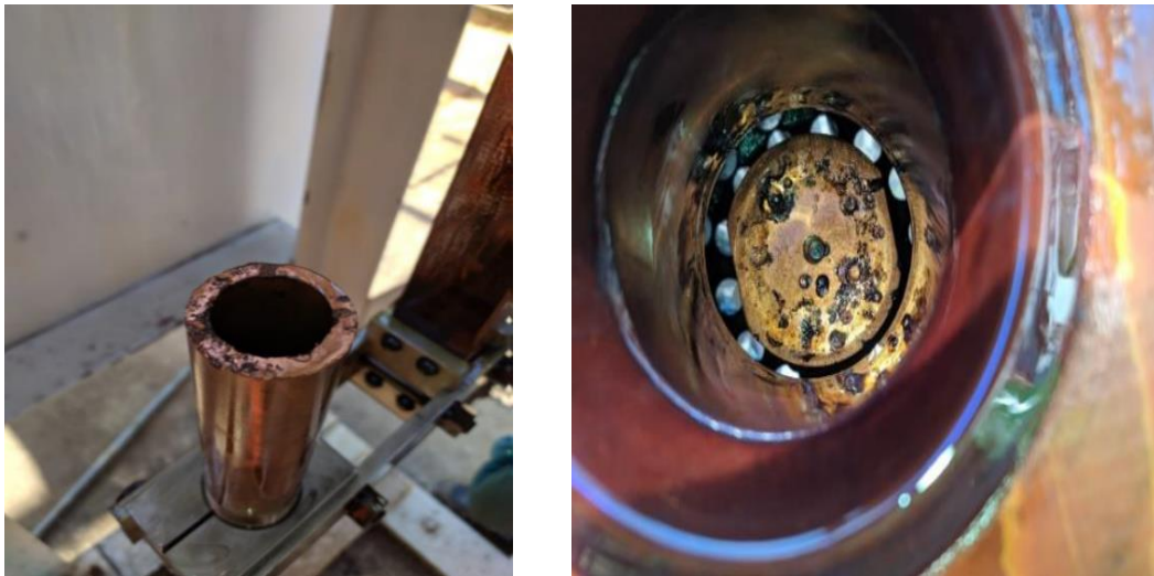
Figura 2 – Contato móvel e contato fixo do disjuntor FK 439 General Electric
