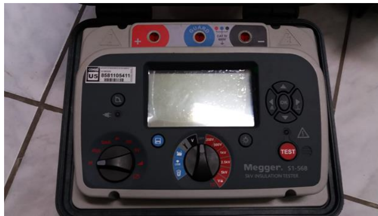
Figura 7 – Megôhmetro utilizado para medição de resistência de isolamento
