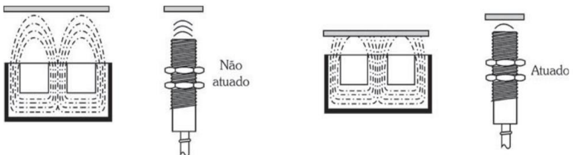
FIGURA 10 - Atuação de um sensor indutivo
