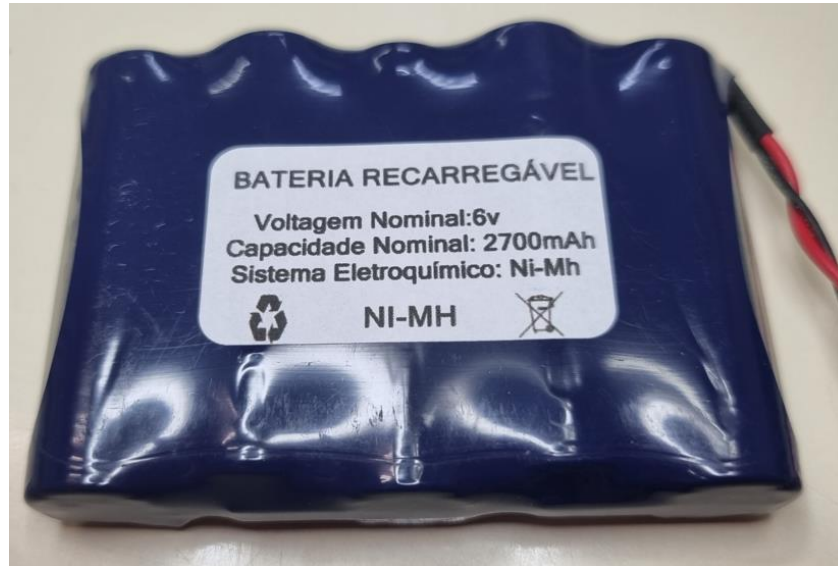
FIGURA 30 - Bateria de hidreto metálico de níquel utilizada no projeto
