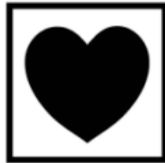
Figura 7 – Símbolo de uma parte aplicada do tipo CF
