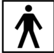
Figura 6 – Símbolo de uma parte aplicada do tipo BF
