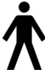
Figura 5 – Símbolo de uma parte aplicada do tipo B
