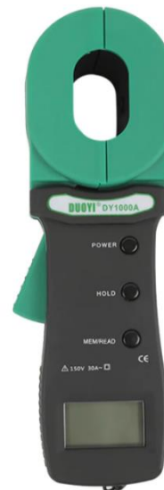
Figura 13 – Alicate Terrômetro utilizado para a medição.
