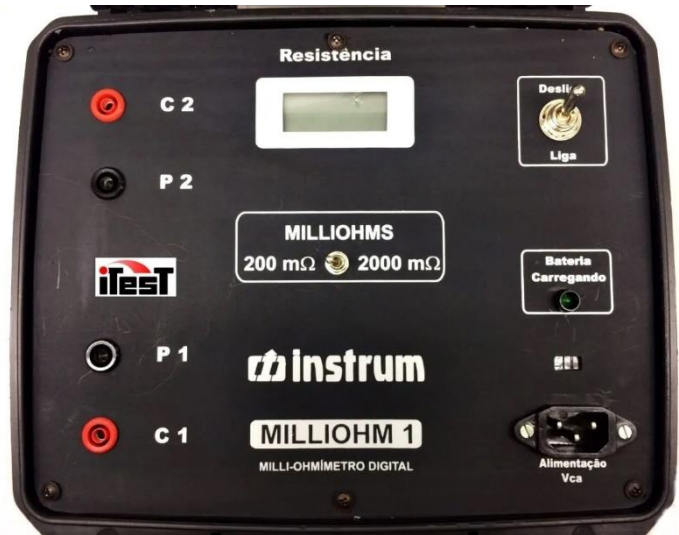
Figura 12 – Miliohmímetro utilizado para a medição.
