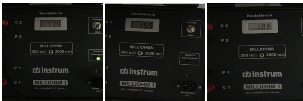
Figura 28 – Medições Captação/BEP de 17,4 mΩ, 15,5mΩ e 18,6mΩ.
