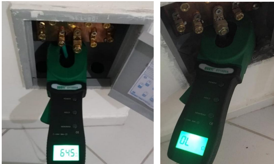
Figura 32 – Medição de laço no BEP de 64,5 \Omega e medição que passou do limite do equipamento.
