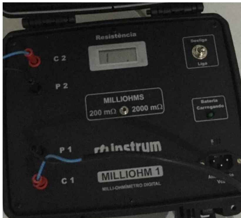
Figura 29 – 4 Medições com leitura acima de 2000 mΩ.
