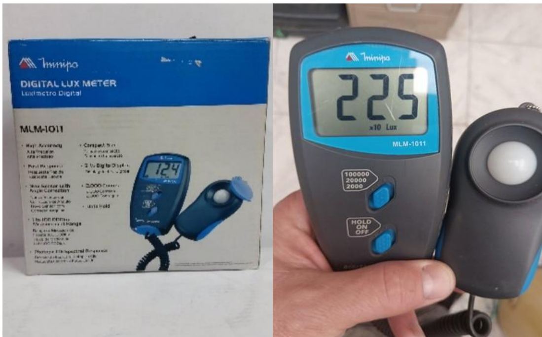
Figura 5 - Equipamento de medição de iluminância, luxímetro MLM-1011.
