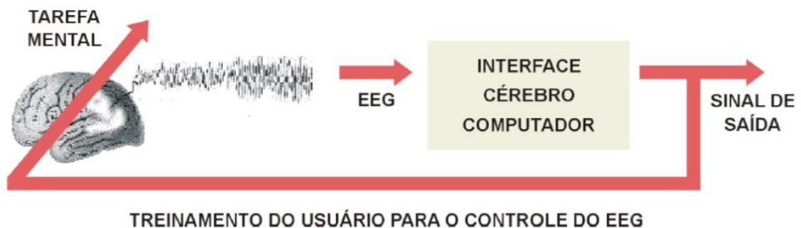
Figura 4 – BCI com abordagem de condicionamento do operador.
