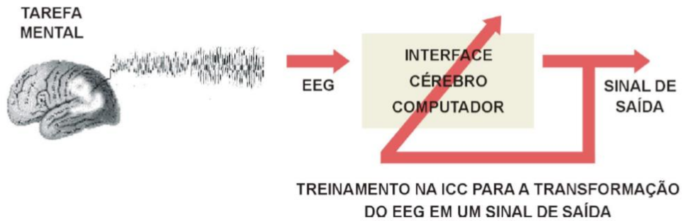
Figura 5 – Treinamento do BCI para transformação do EEG em um sinal de saída.
