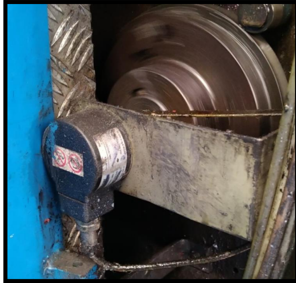
Figura 20 – Fixação do encoder no eixo principal da unidade de impressão
