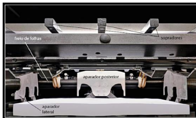
Figura 5 – Componentes do conjunto de recepção
