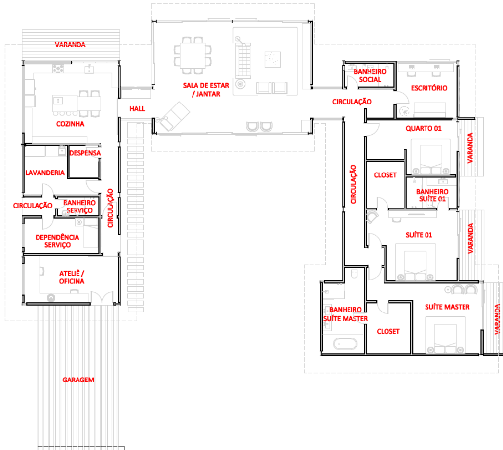
Figura 13 - Planta arquitetônica de uma residência unifamiliar.
