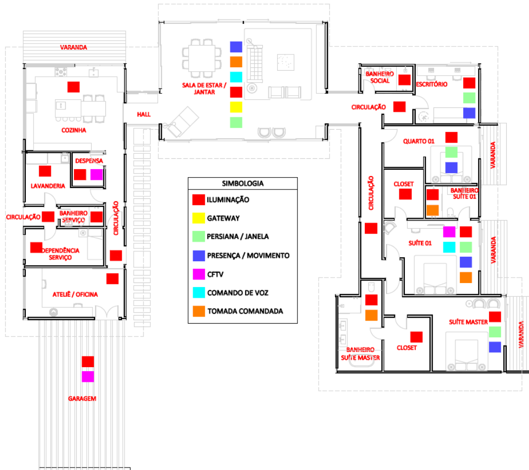
Figura 15 - Planta arquitetônica da automação residencial.
