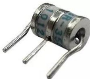
Figura 11: Representação de um centelhador de três eletrodos.
