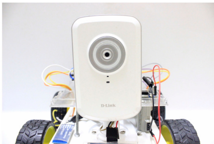
Figura 7. Câmera IP posicionada a frente do robô, neste exemplo, sendo um Sensor Passivo.
