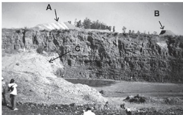
ILUSTRAÇÃO 13 - Detalhe da Mineração Patercal-Partezani em 1999: A e B - acúmulo de detritos na superfície, decorrente da moagem de calcário; C - progressivo entulhamento do afloramento.
