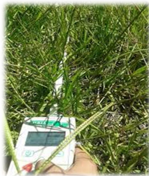
FIGURA 6: Mensuração da radiação fotossinteticamente ativa interceptada com auxílio de um ceptômetro da marca Decagon, modelo LP 80
