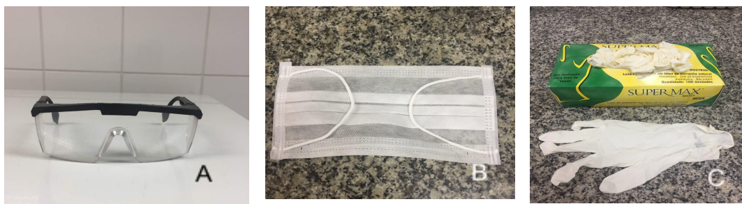
Figura 4 - Prancha com Equipamentos de Proteção Individual (EPI's): A - óculos de proteção; B - máscara de proteção; C - luvas de látex utilizadas em manipulações em laboratórios; D - jaleco. Equipamento de Proteção Coletiva (EPC's): E - modelo de extintor que deve estar em local de fácil visualização e F - caixa coletora de material perfurocortante.
