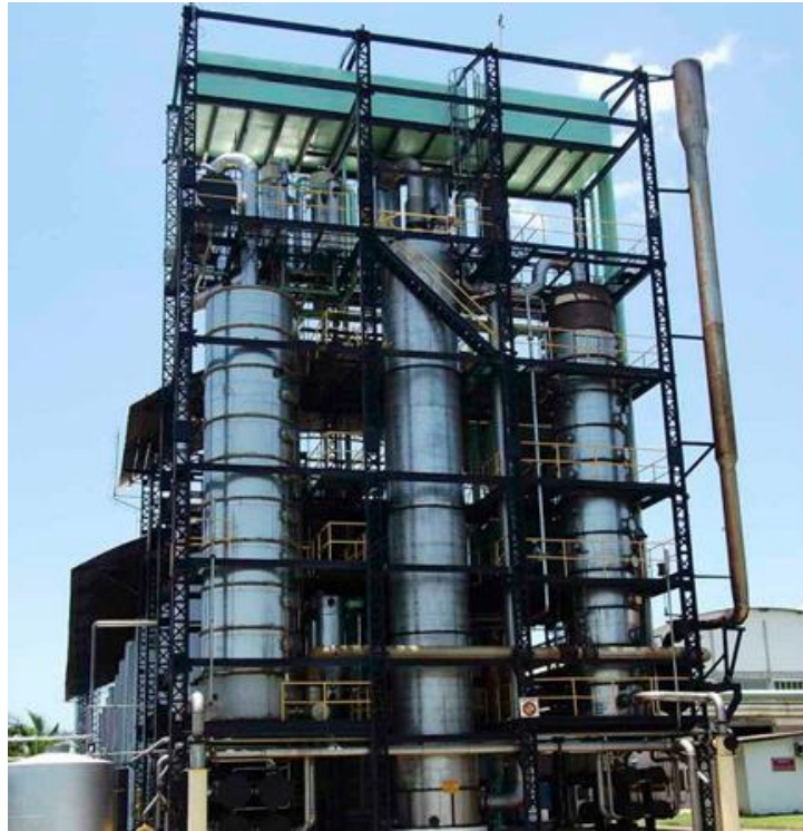
Figura 1: Produção de cachaça em coluna (industrial)
